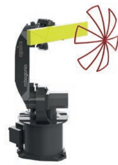
robogonio: Goniophotometer Typ 1.3, C-Ebenen
