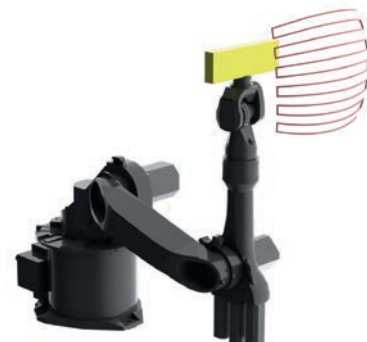
robogonio: Goniophotometer Typ 1.1, A- und B-Ebenen
