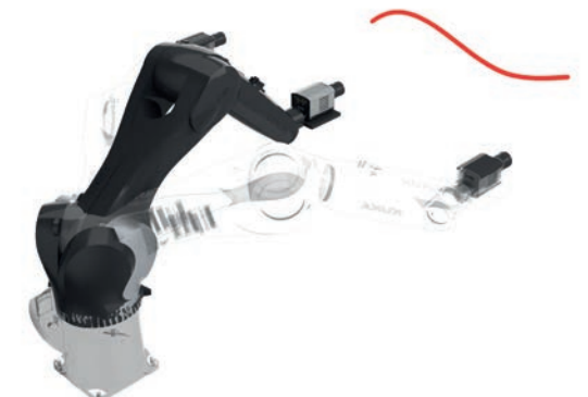
robogonio: Abrastern einer Lichtleiter-Geometrie im Raum
